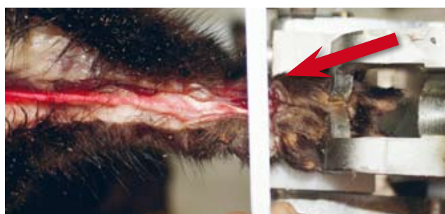
Quick Cut / Combi Cut sikrer dig en optimal opskæring. Snittet fra pote til pote går ud forbi det punkt, hvor tværkniven skærer poten af. På den måde kan du undgå, at skindet får skader på benpartiet.
